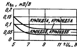
Типовые зависимости коэффициента влияния источников питания на напряжение смещения ОУ К140УД5А, К140УД5Б, КР140УД5А, КР140УД5Б при T = +25^\circ \text{C}
